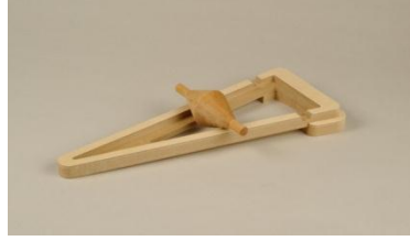
Şekil 4. Beklenen yönün tersine hareket eden düzenek.
