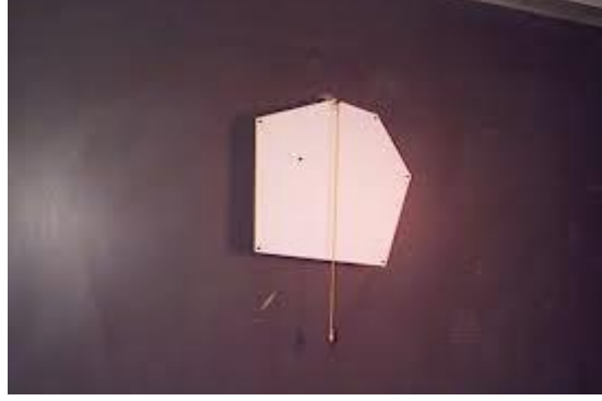
Şekil 7. Duvara asılı geometrik cismin kütle merkezinin bulunması.
